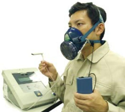
写真5 測定機器によるフィットテスト
